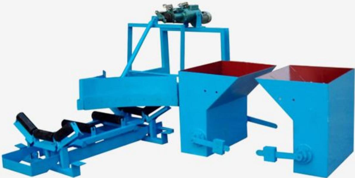
该系列卸料器是我公司引进先进技术，在国内现有犁式卸料器的基础上进行改进而成的一种新型胶带输送机的卸料设备，可广泛应用于电厂、矿山、码头等行业的输煤系统中需中间卸料的场所，是与胶带输送机配套使用的理想设备。
